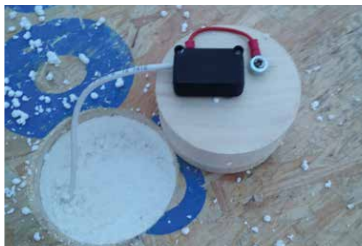
Obr. 8 Umístění senzoru v panelu
